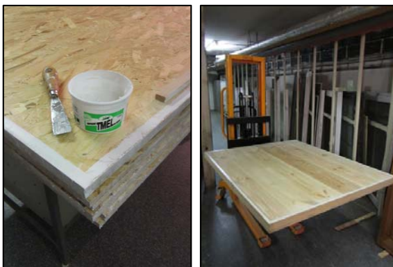
Obr. 3 Úprava skúšobných vzoriek na báze aglomerovaného a masívneho dreva. Fig. 3 The samples treatment oriented strand board and cross laminated timber.
