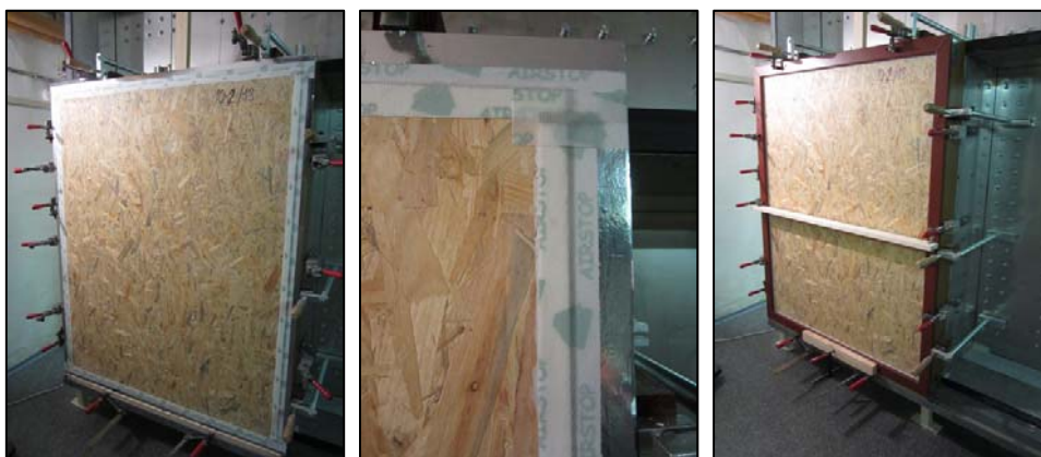
Obr. 4 Vzduchotesné osadenie skúšobnej vzorky a pripevnenie kovového rámu. Fig.4 Airtightness assembly and clamp system of sample.
