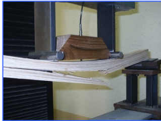
Obr. 1 Skúšobné teleso pri 4–bodovom ohybe so snímačom na meranie priehybu v mieste sily zaťaženia
