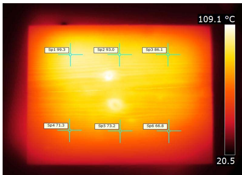
Obr. 6 Termovízny snímok teplotného poľa v doske so šiestimi miestami merania (15. doska 250 \times 200 \times 15 mm) → Obr. 5 = použila sa priemerná teplota zo 6 meraní.
