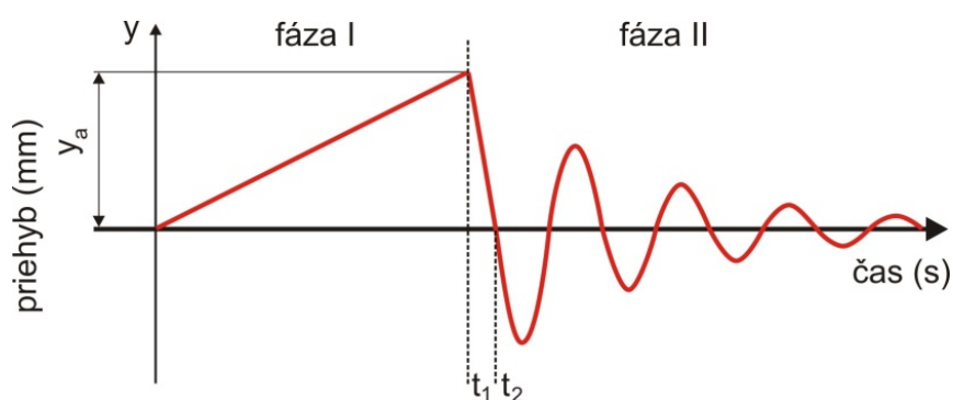
Obr. 1 Schéma určenia času relaxácie (fáza I. – zaťažovanie, fáza II. – uvoľnenie (odťazenie), y_a – veľkosť priehybu [mm], t_1 – čas zaťažovania [s], (t_2-t_1) – čas počiatočnej relaxácie [s]).
