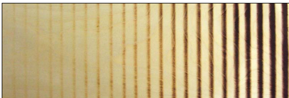
Obr. 2 Povrch vzorky javora po ožiarení laserom Fig. 2 Surface of maple wood after laser irradiation
