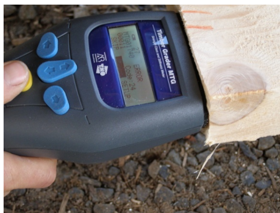
Obr. 5 Prístroj Timber Grader MTG. Fig. 5 Timber Grader MTG device.
