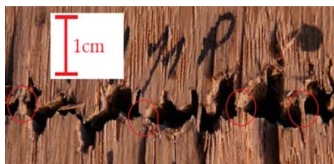
Obr. 5 Šírka reznej škáry dubovej vzorky pri reznej výške (hrúbke) 75 mm, posuvnej rýchlosti 0,2 m·min -1 a hmotnostnom toku abrazíva 450 g·min -1 .
