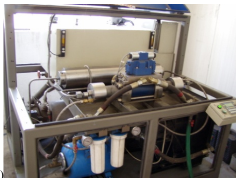
Obr. 1 Technologické zariadenie na rezanie vodným lúčom DEMA spol s.r.o. a) pracovný stôl zariadenia b) čerpadlo vysokého tlaku (multiplikátor).
