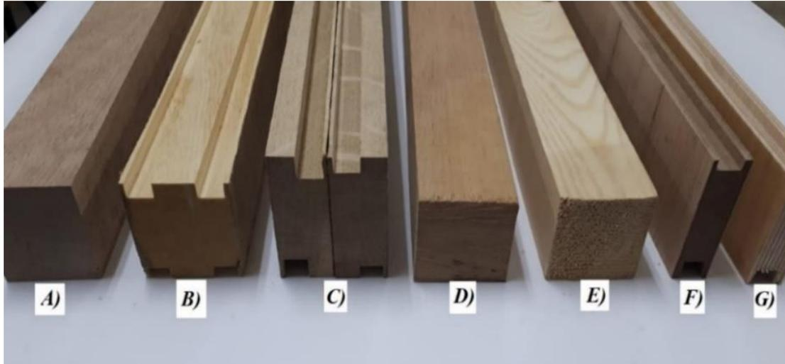
**Fig. 2 Test samples: A) meranti; B) koto; C) oak; D) beech; E) white pine; F) MDF; G) plywood.**
