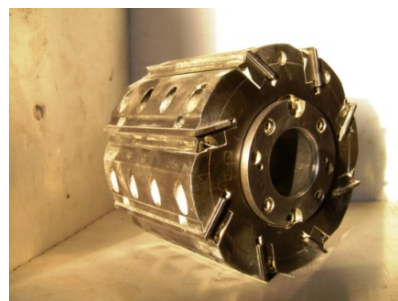
Obr. 5 Osemnožová frézovacia hlava s hydraulickým upnutím na hriadeľi.
