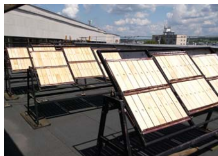
Obr. 2 Telesá smreka vystavené prirodzenému starnutiu podľa EN 927-3 (2013). Fig. 2 Spruce samples exposed to natural weathering by EN 927-3 (2013).
