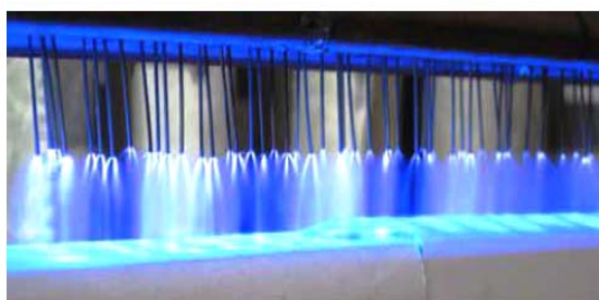
Obr. 1 Predúprava telies smrekového dreva plazmou v zariadení „ADRE plasma“.
