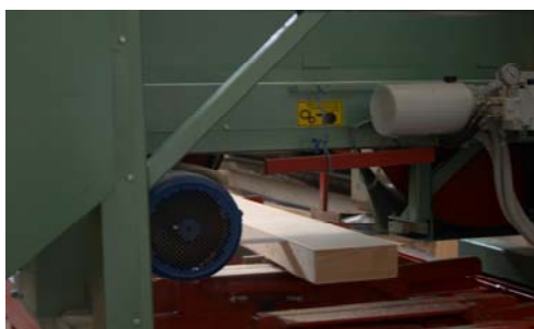
Obr. 6 Pílenie skúšobnýchvzoriek. Fig. 6 Test samples sawing process.
