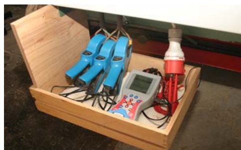
Obr. 7 Meranie rezného príkonu. Fig. 7 Measurement of cutting input power.
