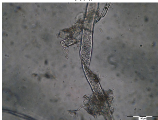
Obr. 8 Mikroskopické snímky papierov z historických kníh. Fig. 8 Microscopic photos of papers from historical books.
