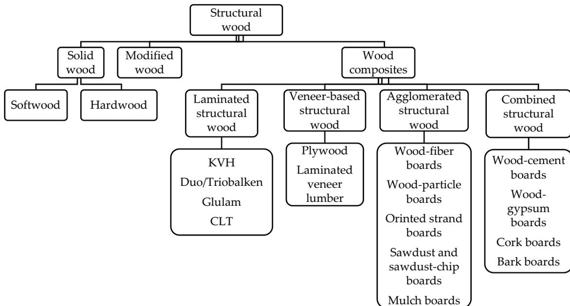
**Fig. 2 Structural wood typology (STN EN 14080).**
