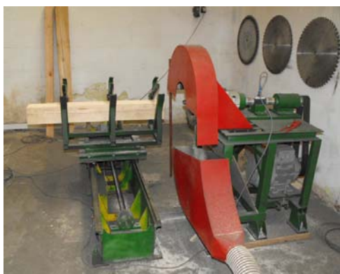
Obr. 2 Experimentálna časť- navrhnutý stand (1. Pracovný stôl, 2. Zariadenie na posuv dreva, 3. Rezný materiál, 4. Remeňový prevod na pohon PK píly, 5. Elektromotor pohonu PK píly, 6. Ložiskový domec, 7. Elektromotor na posuv materiálu do rezu, 8. Vreteník kotúčovej píly, 9. Rezací PK, 10. Snímač krútiaceho momentu a otáčok HBM T20WN, 11. Spojky GIFLEX GFLL- 28, 12. Snímač sily HBM S2).
