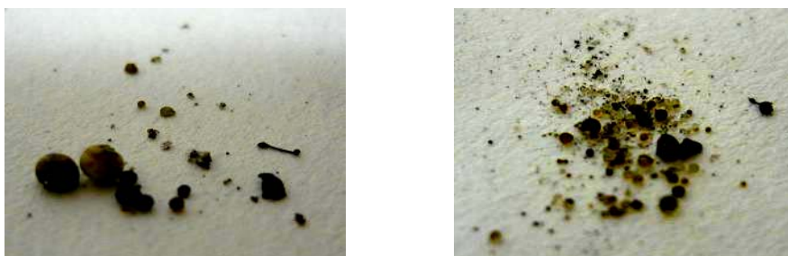
Obr. 7 Roztavená vzorka nepodstatnej zložky sadrokartónovej dosky po skúške spalného tepla Fig. 7 Molten sample piece of non-significant component of the plaster cardboard after the testing of heat of combustion
