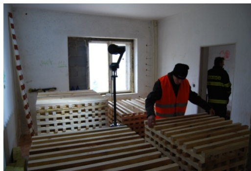
Obr. 5 Nákres a fotografia rozloženia klieťok reziva v jedálni.
