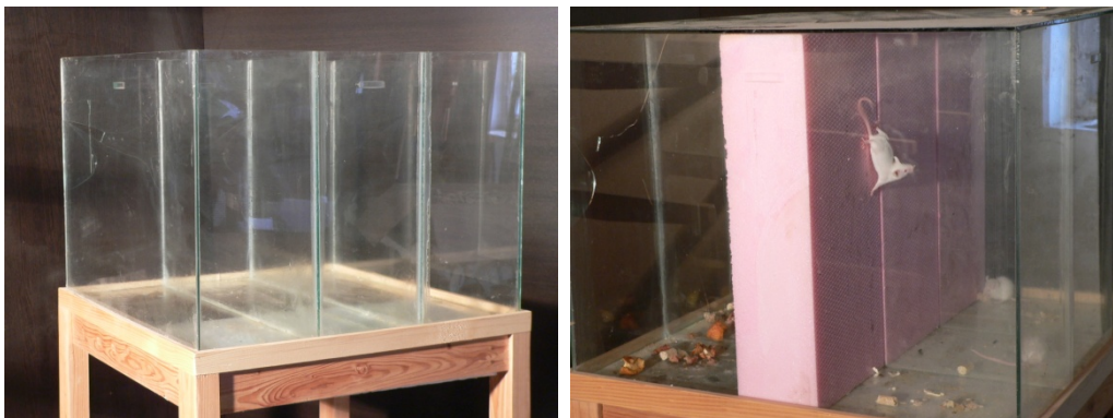
Obr. 1 Sklená nádoba 555 × 545 × 410 mm (dĺžka × šírka × výška → v šírke rozdelená na 3 podsekcie 179 mm) k skúškam odolnosti tepelných izolácií proti aktivite myší.
