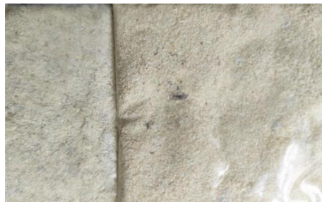
Obrázok 3 Vzorka rozomletých drevených pilín a HDPE
