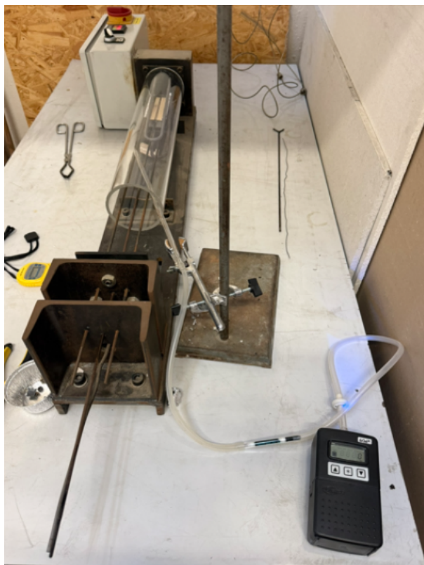
Obr. 1 Laboratórne zariadenie použité na termické zaťaženie vzoriek Fig. 1 Laboratory equipment used for thermal loading of samples
