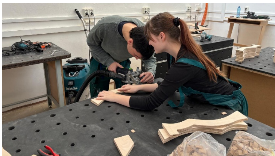
Obr. 5 Proces výroby v dielni – lamelovanie preglejky
