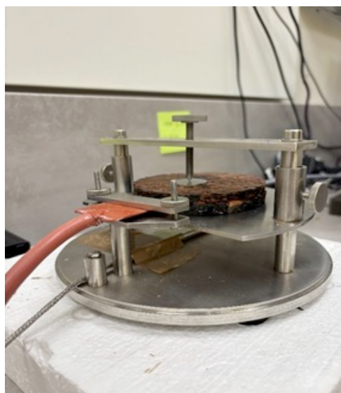
Obr. 3 Meranie pomocou prístroja Hot Disk Fig. 3 Measurement using the Hot Disk device
